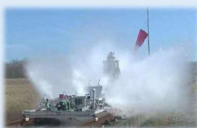
最高時速400kmで走ってくる台車をわずか100mの距離で減速し、安全に停止させる水ブレーキシステムの基盤技術を確立しました。突入速度や水位によって変化する制動力を多数の実験やシミュレーションで明らかにしました。速度低下に応じて徐々に水位の高い区間に突入させる多段階水路の設計プログラムを作成しました。
