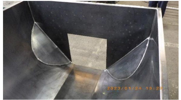
▲円弧滑りの形状。取り出し口を小さくすることで、外気流入による温度低下も防止。
