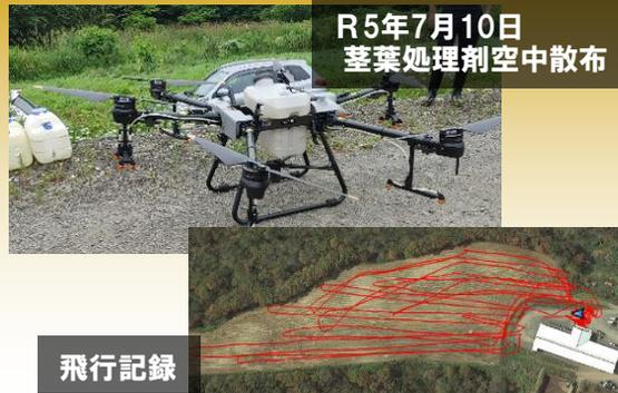
**ドローンによる茎葉処理剤散布を試行！**
